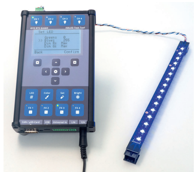
ISELED-Testbox mit angesteuertem ISELED-Streifen
